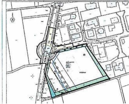
**Alternative 2:** verschieben des Kreisverkehrs für die direkte Anbindung an den Weg des Flurstücks 1141 und Nutzung des Flurstücks 1055/5 als Verkehrsweg. Die Querverbindungsstraße nach Metlangen besteht bereits als „Durchgangsstraße“.
