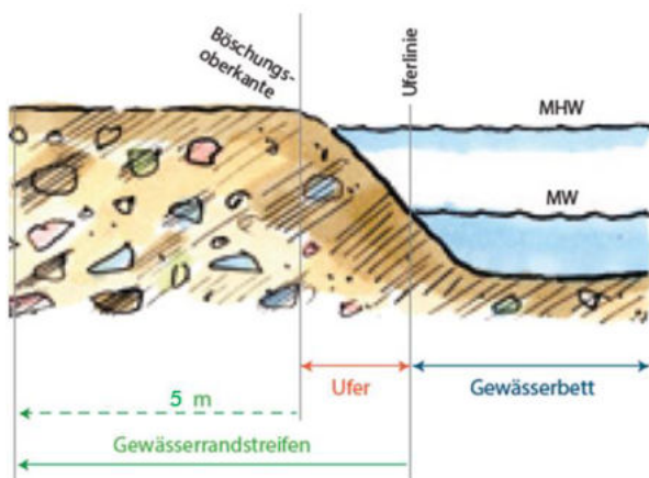
Abb.: Definition des Gewässerrandstreifens (Bauverbot im Gewässerrandstreifen), diese ist unabhängig von Grundstücksgrenzen.
